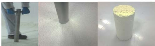
Figure 1 : Prélèvement des éprouvettes par carottage
